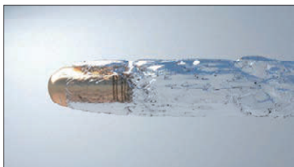
水中を高速で進む物体のキャビテーション現象
