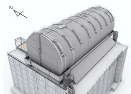
図10 3号機燃料取り出し用カバー等イメージ
