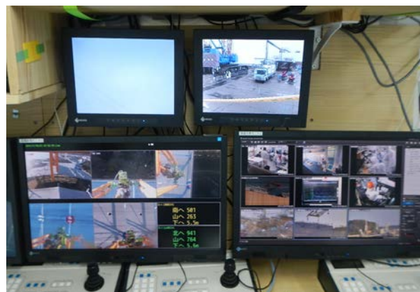
写真1 誘導モニター (複数のカメラ映像、吊り治具の位置を数値で表示)
