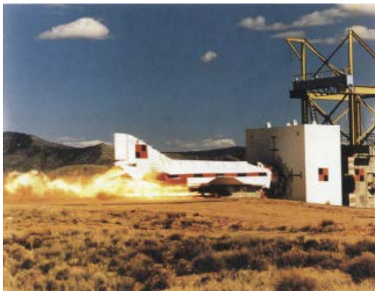
写真2 F4-Phantom 戦闘機を用いた衝撃実験状況 5)
