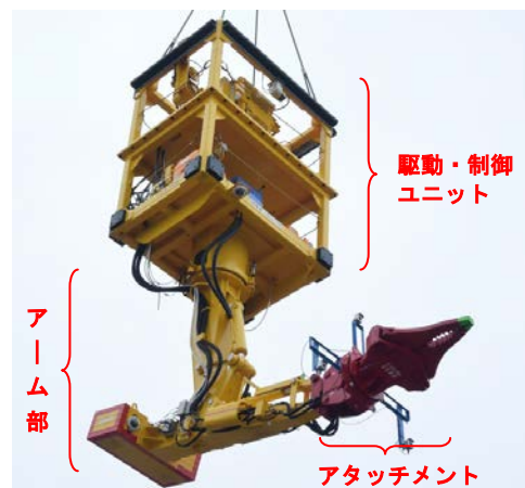
写真 5 装置全景 (クレーンで吊り下げて使用) 重量： 約 18t 駆動装置： 油圧
