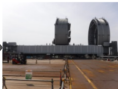
図 12 ドーム屋根スライド試験
