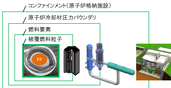
図2 事故時放射性物質閉じ込めに係る物理的障壁
