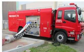
可搬型の送水ポンプ
