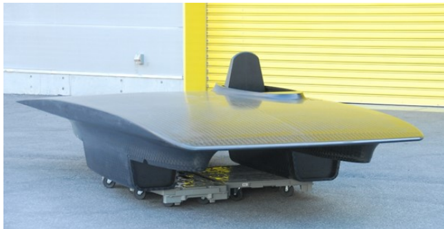
図3 炭素繊維強化プラスチック製軽量ボディ
