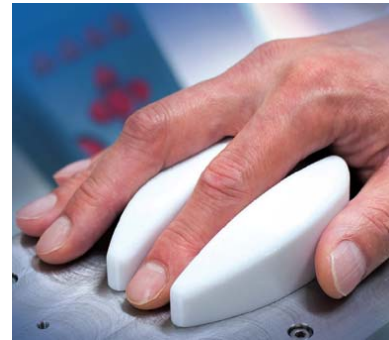
図 2. 採血が不要、体を傷つけず（非侵襲）、指先を光にかざすだけで約 5 秒で血糖値を計測
