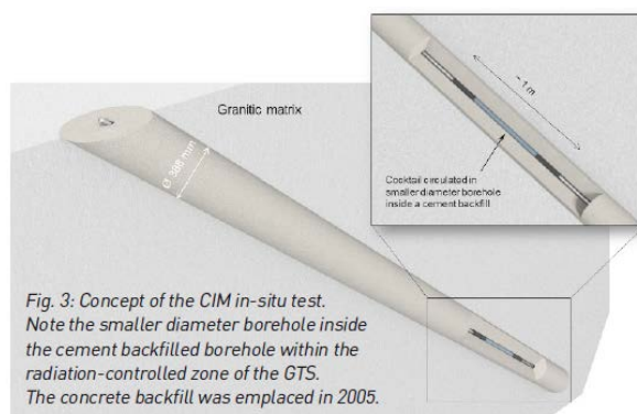
図-2 CIM における原位置試験の概念図 3)
