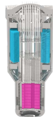
図 2 一体型原子炉の概念図 (軽水小型 PWR)
