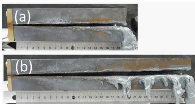
図 2. 压力容器を模擬した厚板鋼材の切断結果
