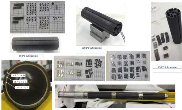
図 RB*カプセルの試料とホルダー
