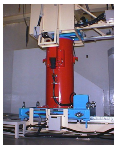
デブリ収納缶非破壊測定 シミュレーションモデル
