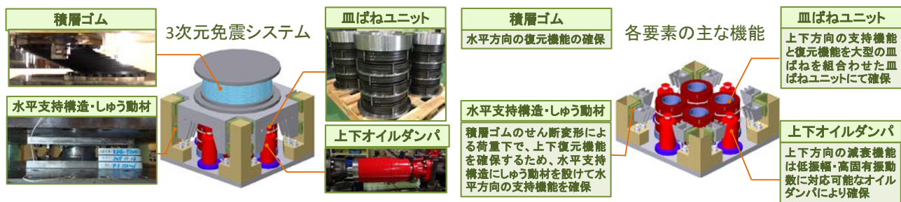
図3 3次元免震システムの構成及び各要素の主要な機能
