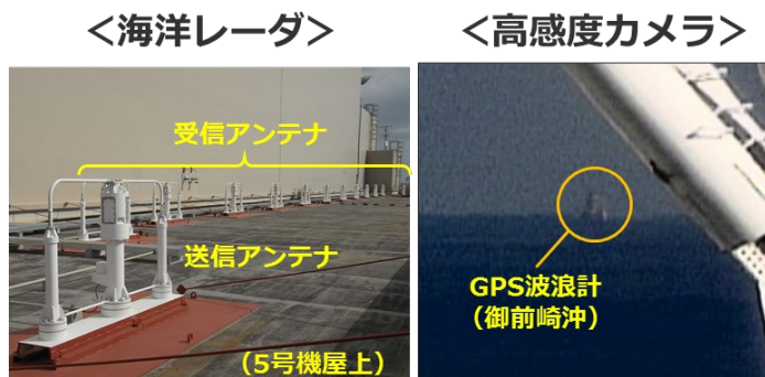
図 2 津波監視システム（浜岡原子力発電所で観測）
