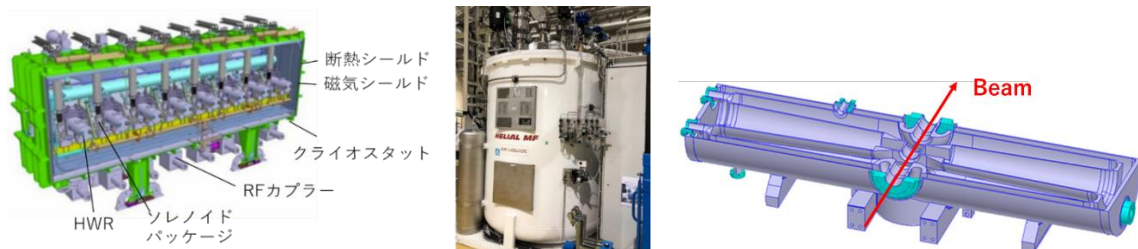
図 1. LIPAc の SRF クライオモジュール(左)と冷凍機システム(右). 図 2. LIPAc の HWR 空洞.
