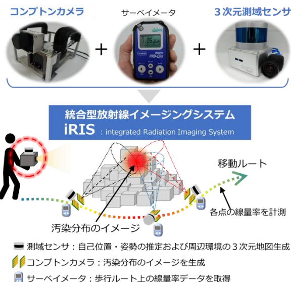
図1. 統合型放射線イメージングシステム iRIS の概略図。コンプトンカメラと3次元測域センサ (SLAM 機器) およびサーベイメータを組み合わせた。オペレータが携帯もしくはロボットに搭載したシステムを用いて作業現場をスキャンし、ホットスポットや移動ルート上の線量率を可視化した3次元マップ生成のためのデータを取得する (令和3年度 福島研究開発部門 成果報告会資料より転載[6])。
