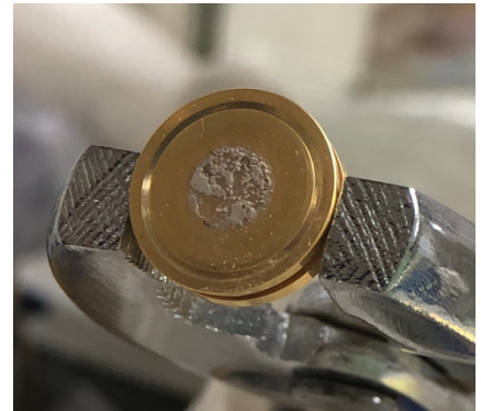
図 1 照射後の電着物の様子
