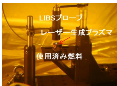
図3 使用済み燃料での試験 [3]
