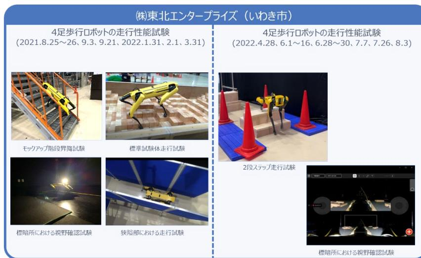
図7 地元企業によるロボット性能試験
