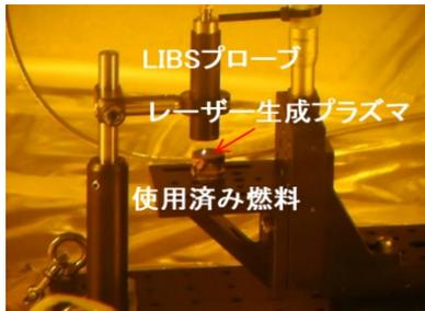
図3 使用済み燃料での試験<sup>[3]</sup>
