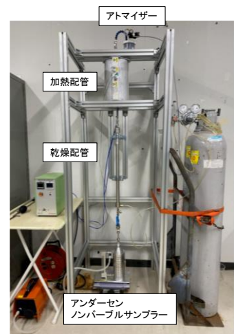
図 1. 構築した実験装置
