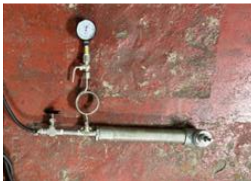
Fig. 3 疑似ガス漏洩装置
