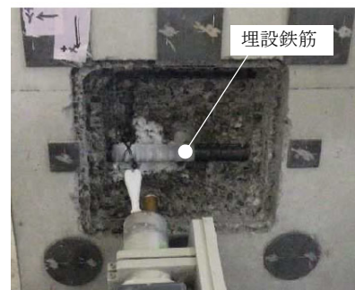
図-3 大型コンクリート試験体 (金物撤去後)
