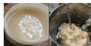
Fig. 1 けん化反応生成物の状態。(左)DPG を添加せずに加熱開始1時間経過後, (右)DPG を添加して20 分攪拌後。
