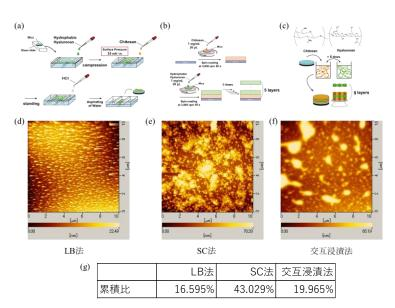
図 1(a)LB 法による累積法(b)SC 法による累積法(c)交互吸着法による累積法(d)LB 法累積の AFM 画像(e)SC 法累積の AFM 画像(f) 交互法の AFM 画像(g) 3 方法の累積比
