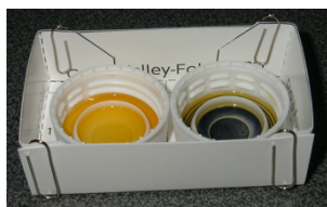
図2 ヨウ素デンプン反応 左：うがい薬のみ 右：うがい薬+片栗粉(デンプン)
