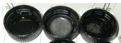
図4 水(15滴)に対する溶解性 左：マレイン酸 中：フマル酸 右：コハク酸
