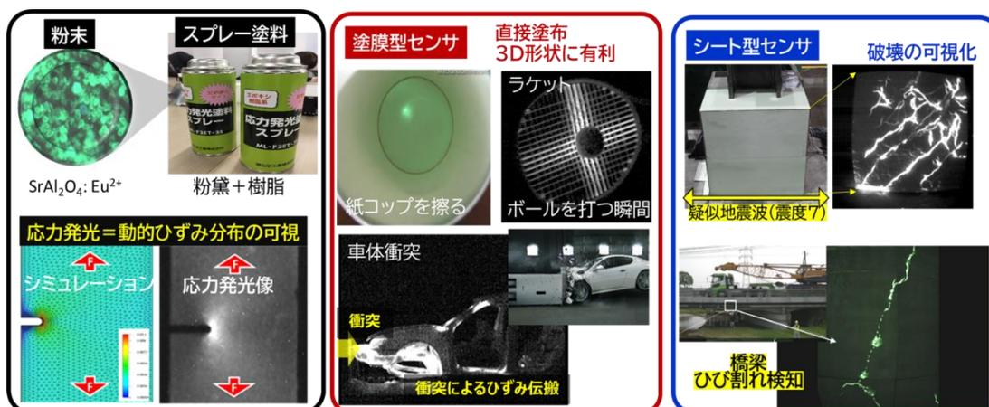
図1 応力発光材料、センサの特徴(塗料型・シート型)、アプリケーション例
