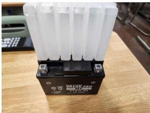
図.即用式バッテリーと使用済の硫酸容器
