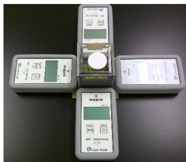
図2 放射性物質の透過度測定
