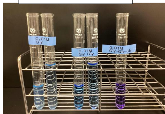
図 3 銅とグリシン、銅とジペプチド(グリシルグリシン)、銅とトリペプチド(グリシルグリシルグリシン)がつくる錯体の比較
