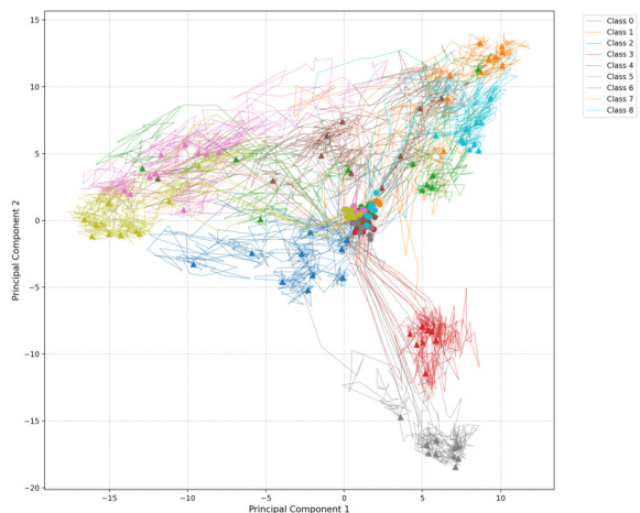
図 5: ファインチューニングにおける埋め込み点の軌跡。各色は属するクラスを表し、丸はファインチューニングをする前の点、三角形はファインチューニング終了時の点を表す。
