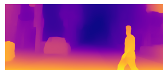
図 4: MiDaS による出力結果 (深度マップ)
