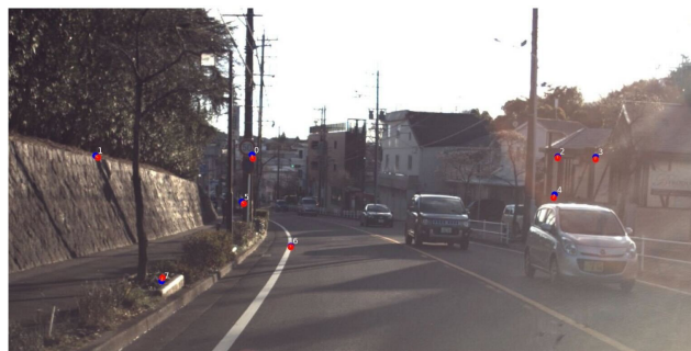
図8 位置推定誤差が 1 m 未満の対応付け結果 青点：カメラ画像の特徴点 赤点：三次元点群地図の特徴点 黄線：距離学習モデルによって算出された対応関係
