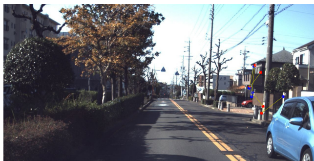
図9 位置推定誤差が最大時の対応付け結果 青点：カメラ画像の特徴点 赤点：三次元点群地図の特徴点 黄線：距離学習モデルによって算出された対応関係
