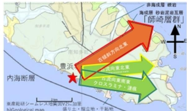
図2. 古傾斜の方向と主要な古流向と内海断層の走向との関係
