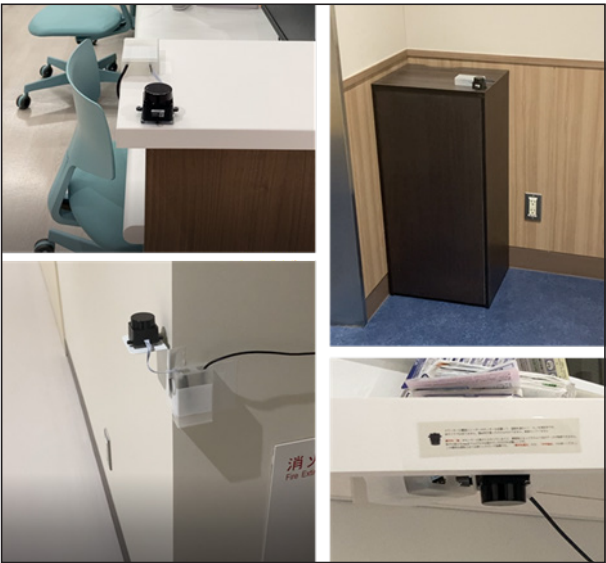
図 3 計測ユニットの設置例 (左: カウンター上 [No. 1], 右上: 台の上 [No. 16], 左下: 壁面 [No. 17], 右下: 作業デスク裏面 [No. 3])
