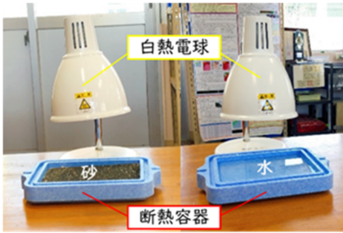
図1 砂と水の比熱の違いを調べる装置
