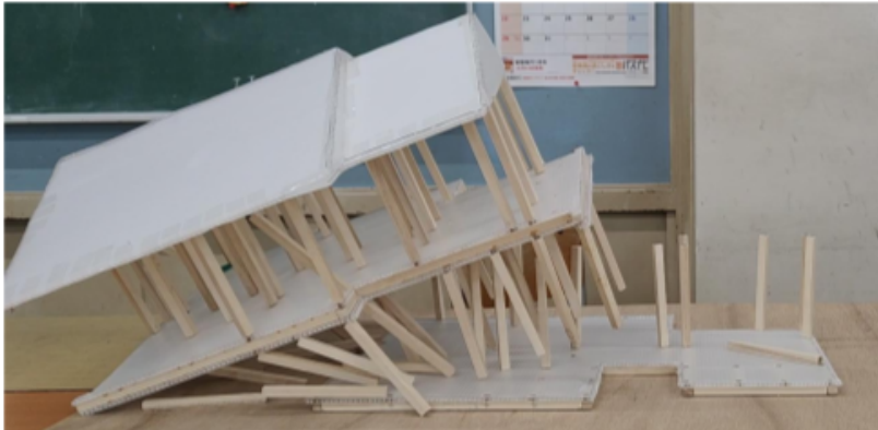
(図10) 倒壊した住宅模型 (Fig10) Collapsed house model
