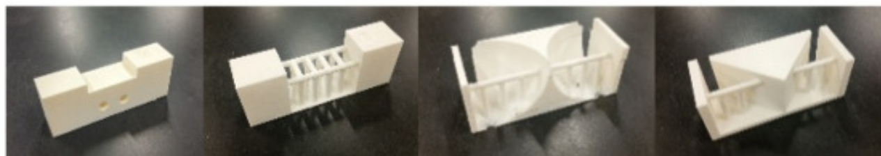
図1 砂防堰堤模型(左から不透過型・透過型・タイプA・タイプB)←
