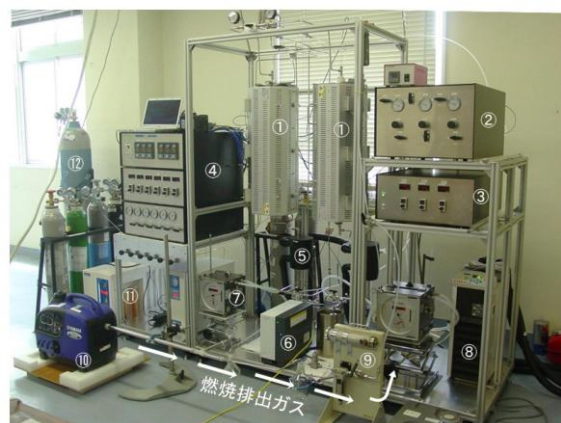
① 反応電気炉(2連式) ② ガス混合器 ③ サーマルマスフロー ④ 電気制御系 ⑤ コールドトラップ ⑥ マイクロガスクロマトグラフ ⑦ 湿式ガスメーター ⑧ 冷却水循環装置 ⑨ 水分除去フィルタ ⑩ ガソリン燃焼発電機 ⑪ 水素&酸素発生器 ⑫ ガスポンペ類
