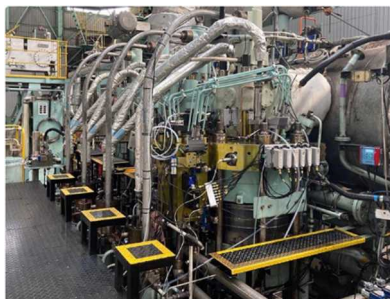
図1 水素燃焼試験を実施した船用エンジン
