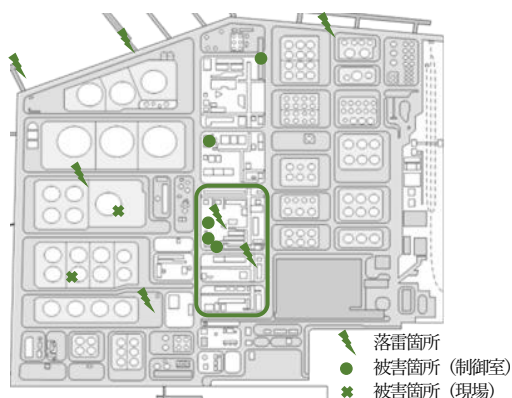
Fig.1 落雷箇所および被害概要
