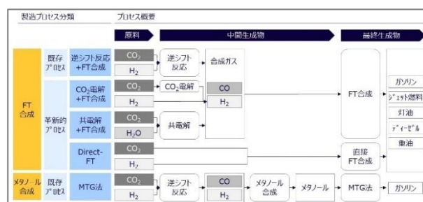
図 2 合成燃料製造の主なプロセス
