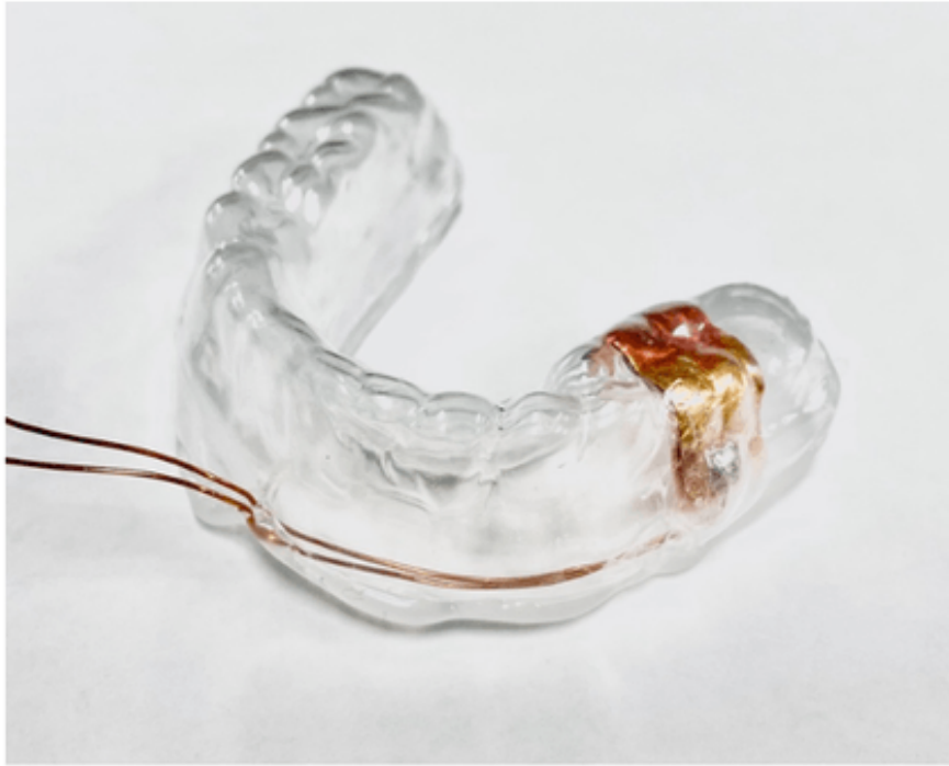
図1．咬合力測定装置のプロトタイプ of 1 例
