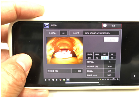
図 3 スマホから、遠隔でミニマルファブの RCA 洗浄装置を制御しているところ。別に特段の準備無しに普通に使える。
