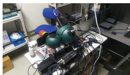
図 1 積分球を用いたリニアリティ評価装置
