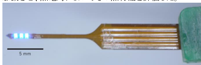
Fig. 1 : ChR2 を刺激するための青色 LED を実装した光刺激デバイス
