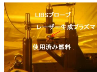
図2 使用済み燃料での試験
