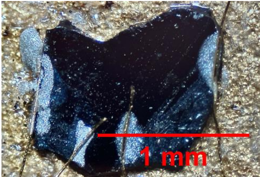
Fig. 1 溶融凝固法により育成した Sr 2 CoCu 2 Se 2 O 2 の単結晶
