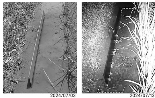
(a)開始時 (b)10 日後 図 2. 常設型電気誘引装置(試作機)の電極周辺に誘引されたジャンボタニシ (2024 年 7 月 3 日~13 日; 熊本県熊本市)
