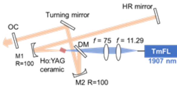
図 1 Ho:YAG セラミックレーザー発振器構成
